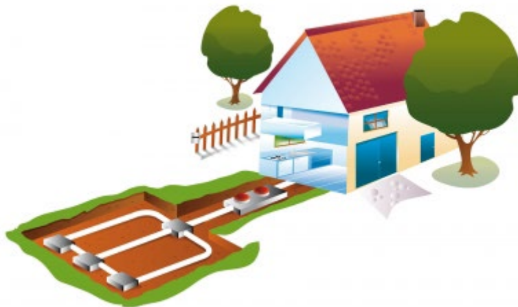
Slika 6: Prikaz delovanja toplotne črpalke zemlja-voda
